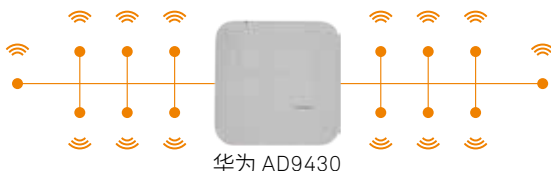
图 1 华为敏捷分布式 AP 系统架构图
